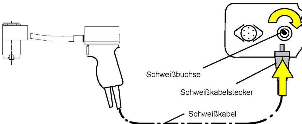
Sichern Sie die Steckverbindung durch kräftiges Drehen des Steckers nach rechts bis zum Anschlag.
